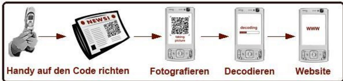
So funktioniert das Entschlüsseln eines QR-Codes mit einem QR-Scanner auf dem Smartphone.
